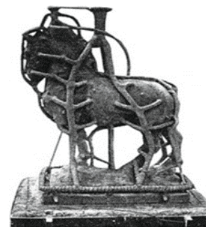
Apparato per la fusione di un cavallo. Si notano i condotti di aspirazione atti a facilitare la colata e il sostegno della forma.
